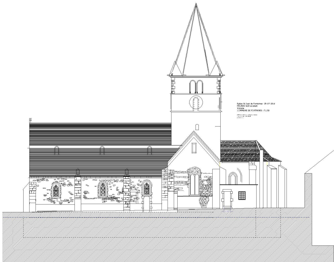
Façade Sud (pente transept et état de la terrasse sacristie à vérifier à la nacelle)
