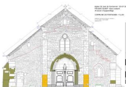
Relevé appareillage de la façade Ouest- rehausse (avant 1701 ?) des bas-côtés visible dans les changements d'appareillage.
